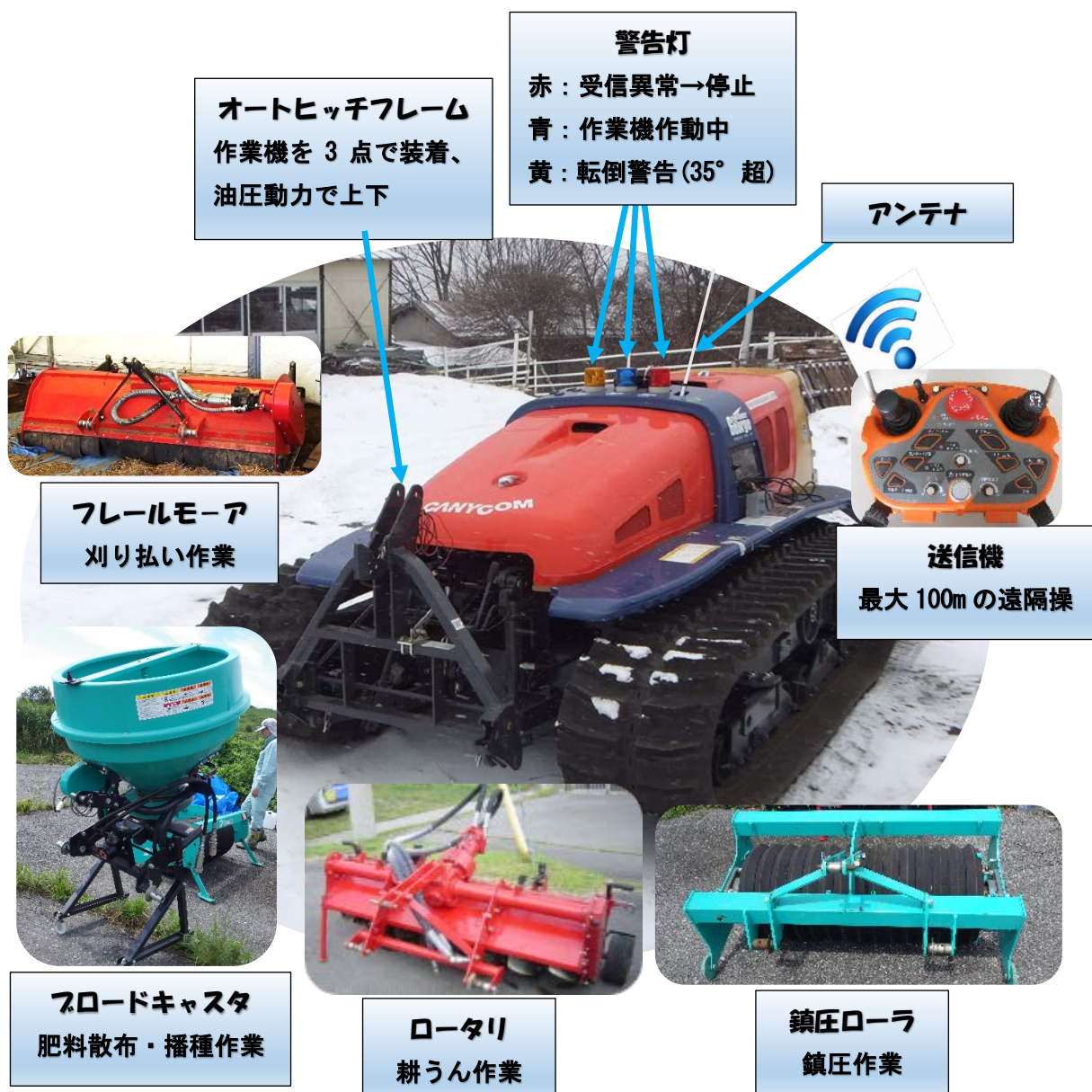
図 1-1 急傾斜草地の草地更新に用いるトラクタと作業機
