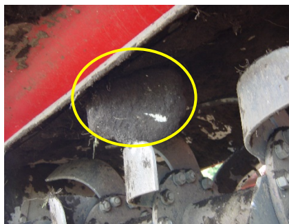
図 4-3 爪とカバー間の石の詰まり
