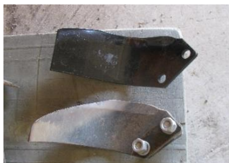
図 4-6 新品のロータリ爪 (上) と摩耗した爪 (下)
