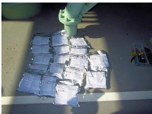
図6. リン化アルミニウム袋入り粉剤 パック(1 袋 34g×10 連が封入)
