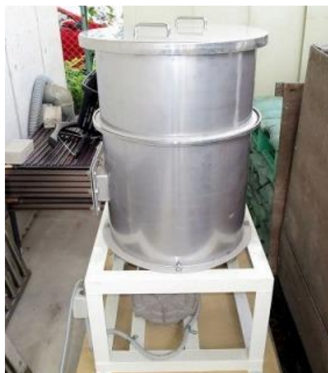
図 10. リン化アルミニウム残渣処理機
