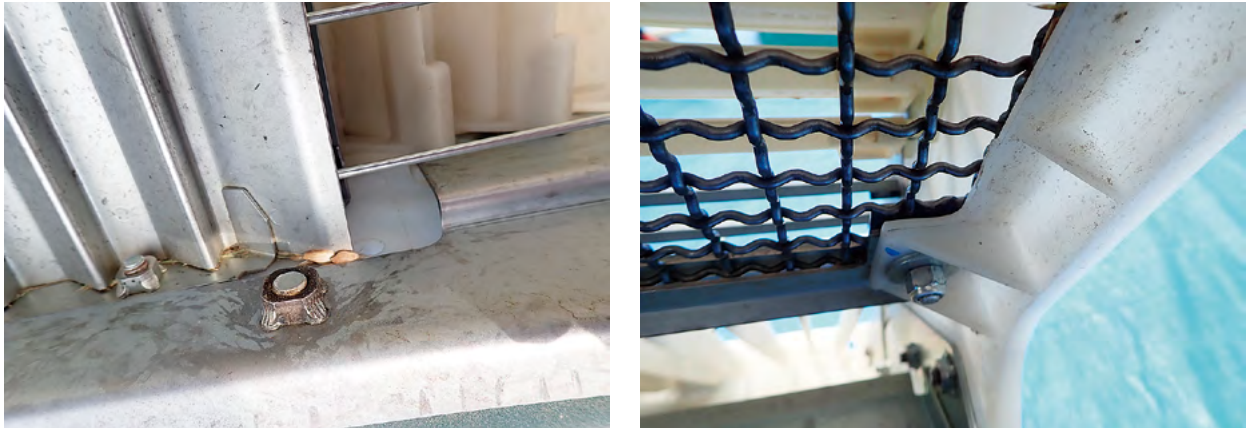
図2-6-11 揺動板の穀粒残留がみられる箇所（左：フィン、右：受け網）
