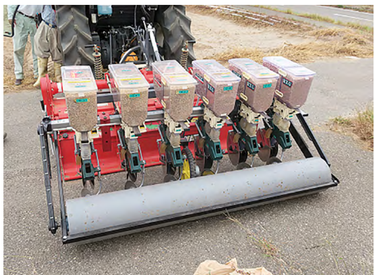
図2-2-1 全面鎮圧スライドロール式播種施肥機（車速連動モータ駆動）
