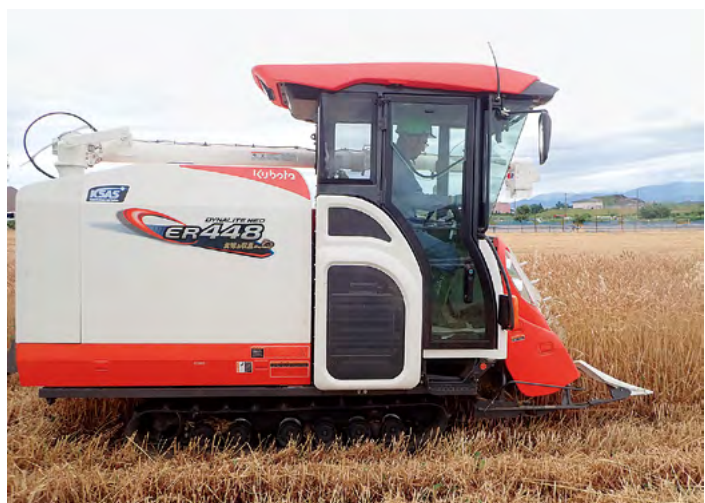
図2-6-1 食味・収量センサ仕様4条刈り自脱コンバイン（クボタ ER448）
