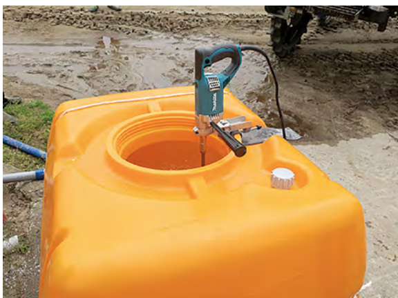
図3-1-9 電動攪拌機を取付たローリータンク
