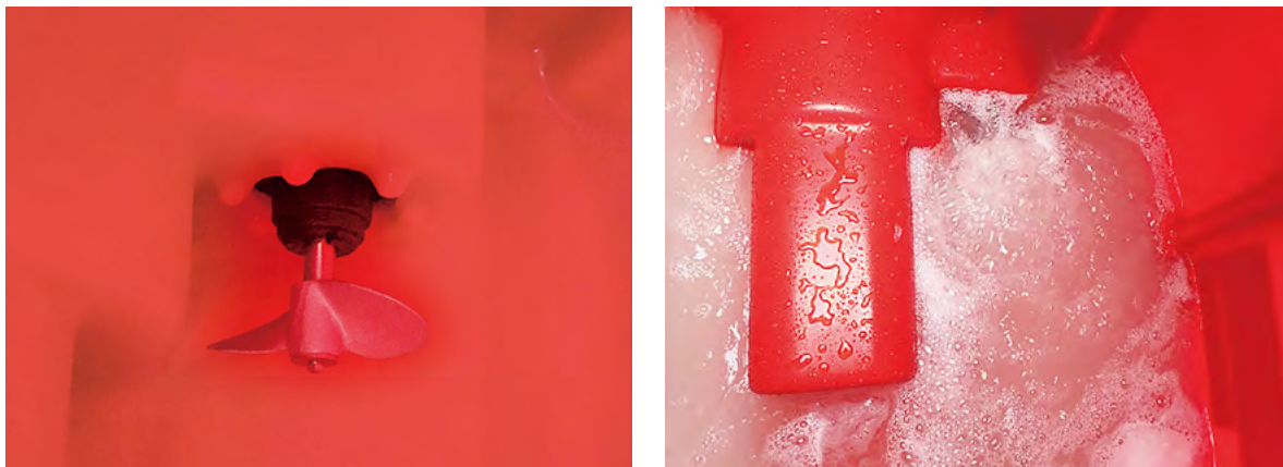
図3-1-6 ブームスプレーヤの攪拌機能（丸山製作所 BSA-650の場合） 左：機械式攪拌、右：攪拌の様子（水流ができています）
