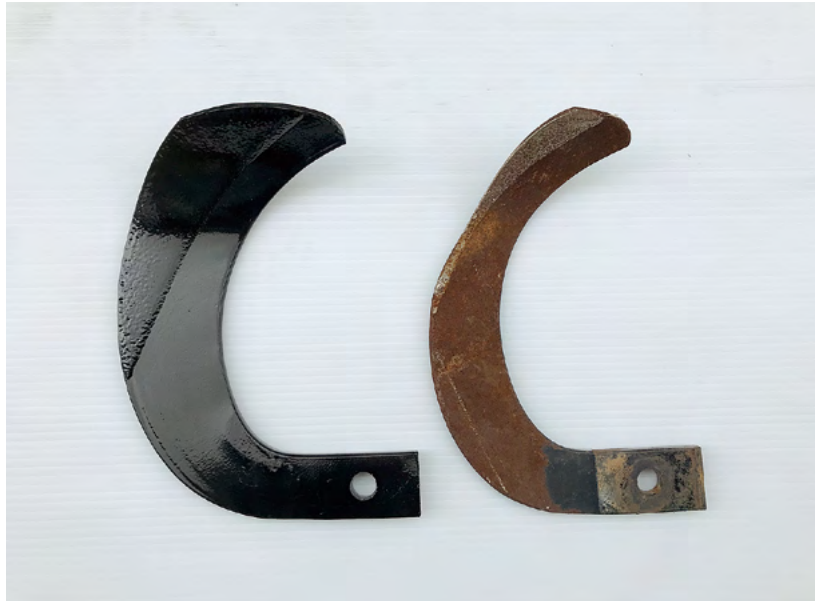
図2-2-2 耕うん爪の摩耗（左：新品、右：約3cm摩耗）
