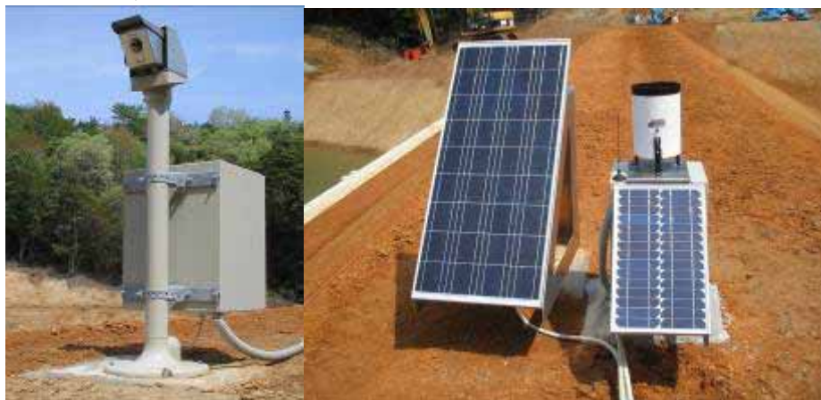
写真5 リアルタイム計測システム (左:リアルタイムモニター, 右:雨量計・水位計の観測システム)
