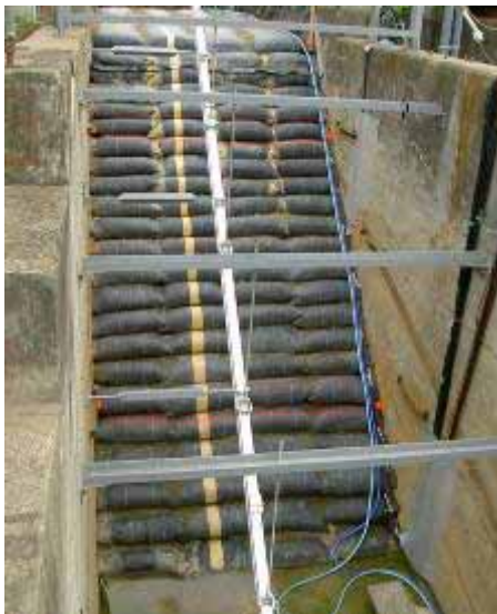
写真1 実物土嚢を用いた越流実験
