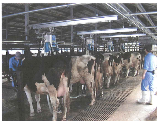
図 6-12 E 牧場での搾乳ユニット自動搬送・2頭同時搾乳の様子
