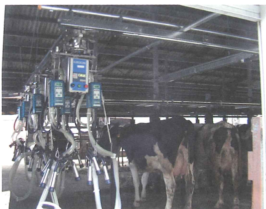
図 6-12 E 牧場での搾乳ユニット自動搬送・2頭同時搾乳の様子
