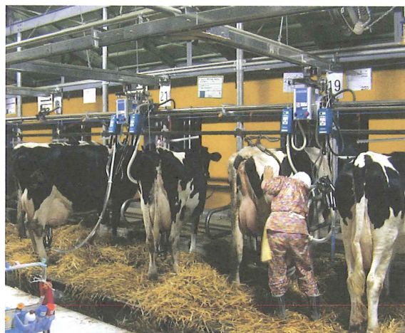
図 6-7 B 牧場での搾乳ユニット自動搬送・2頭同時搾乳の様子
