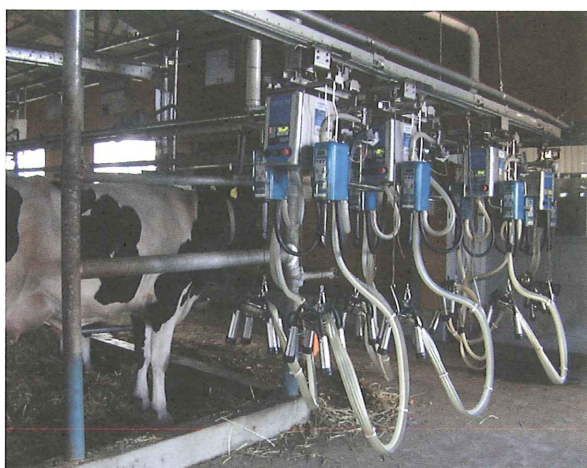
図 6-7 B 牧場での搾乳ユニット自動搬送・2頭同時搾乳の様子
