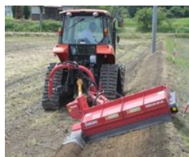
図 2 法面土削り取り機
