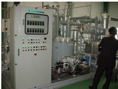
図5 過熱メタノール蒸気法に基づくパイロットプラントの外観
