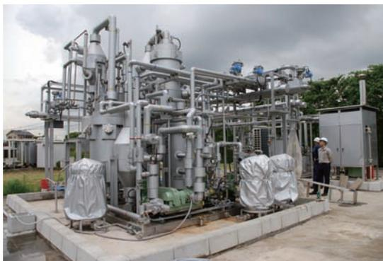
図6 過熱メタノール蒸気法に基づく実証プラントの外観
