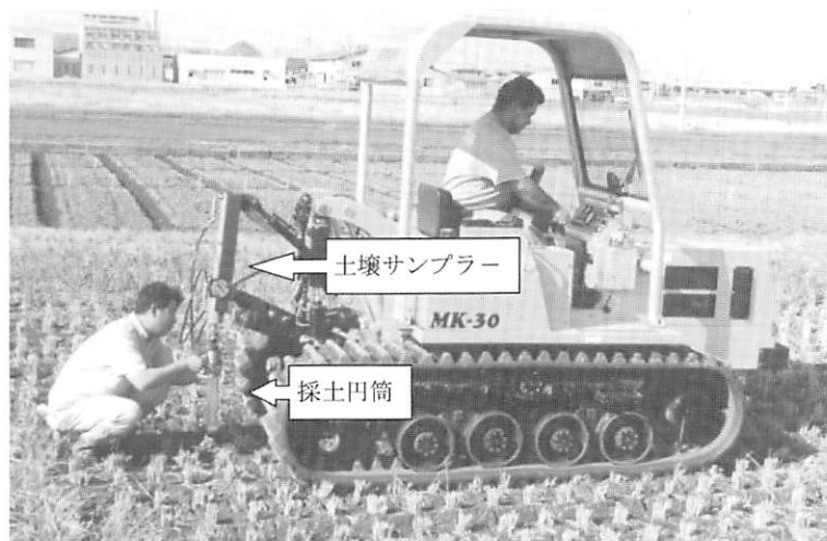
図3-2 開発した土壌サンプラーとその作業風景
