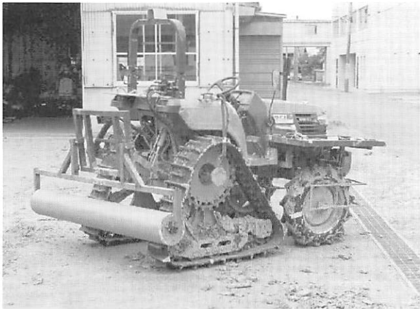
図11-5 セミクローラトラクタに装着した轍均平ローラ
