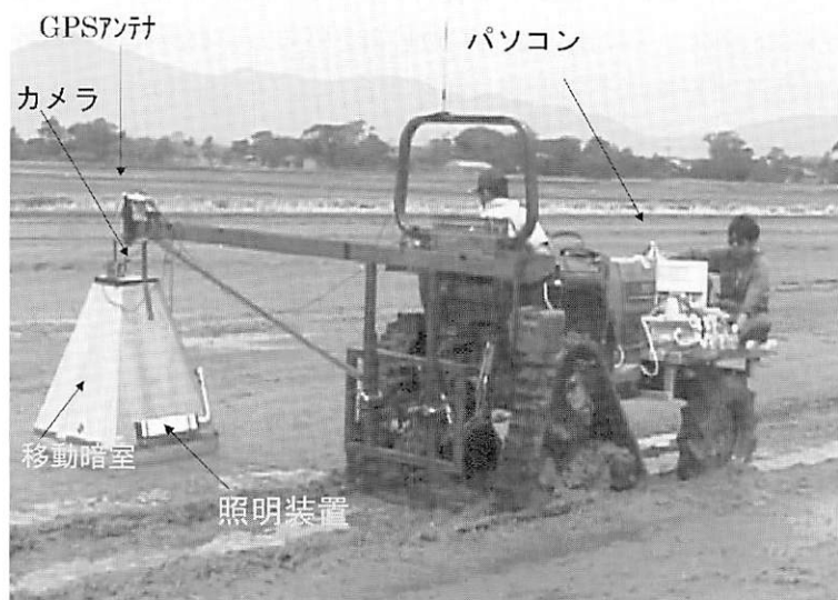
図3-4 苗立ち計測数システムの概要
