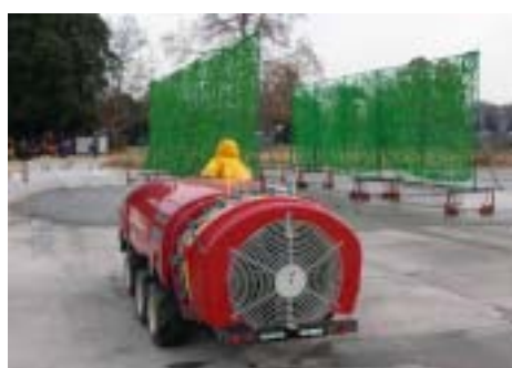
図1 模擬樹を利用したドリフト試験法
