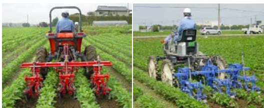
図1 開発機の外観（左：トラクタ用、右：乗用管理機用）
