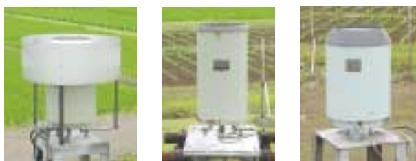
図2 比較した降水量計。左から溢水式、転倒ます式、温水式。溢水式には風除けを付けて用いる。口径はどれも同じく直径20cmである。開口部の高さを3.5mにそろえて設置した。
