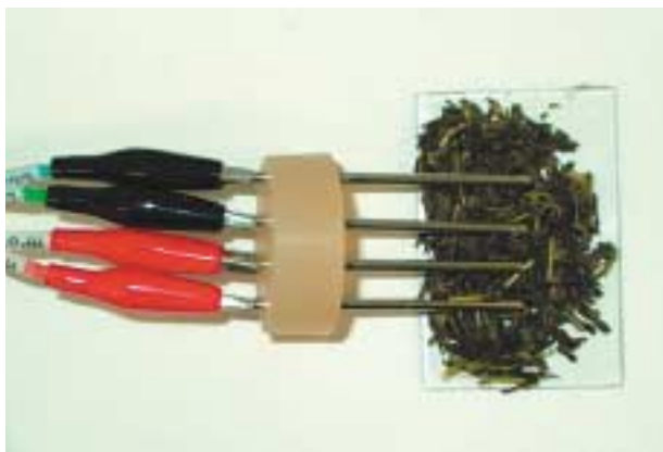
図1 4端子電極による茶葉の電氣的計測
