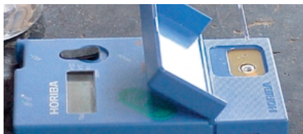
写真1 コンパクトイオンメーターを用いたナトリウムイオン濃度測定
