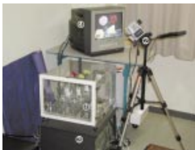
図1 エチレン感受性検定用ビデオシステム エチレン処理用チャンバー ビデオカメラ ハードディスクビデオレコーダー TVモニター
