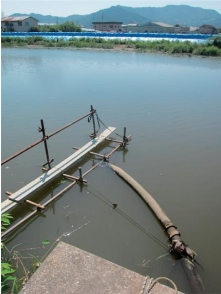
Fig.2 取水用ホースとECロガーを設置した栈橋
