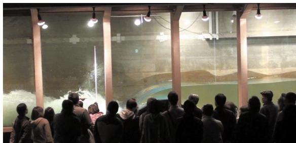
写真 津波実験の様子。実験水路の中で、津波が模型の堤防を乗り越えていく瞬間と見学者の方達
