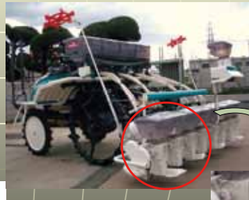
・ 鉄コーティング用播種機(表面播種機)
