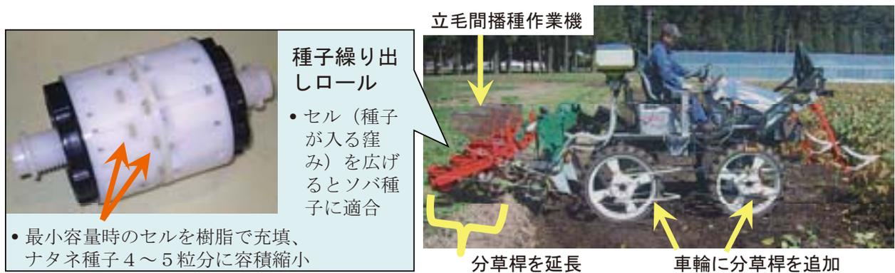
図1 ソバ・ナタネ用に改造した立毛間播種機
