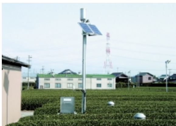
図6 電撃型自動計数フェロモントラップ設置事例
