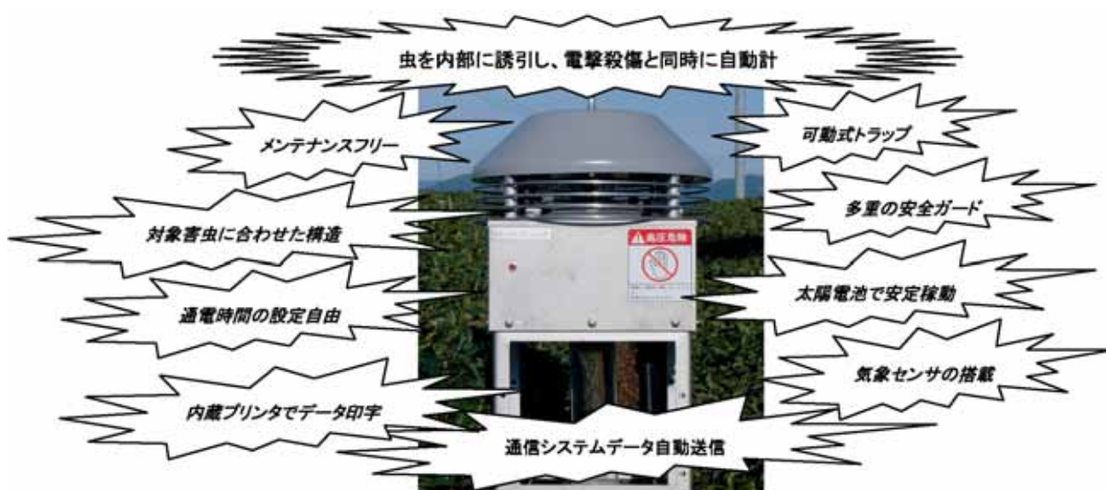
図5 電撃型自動計数フェロモントラップの仕組みと特徴
