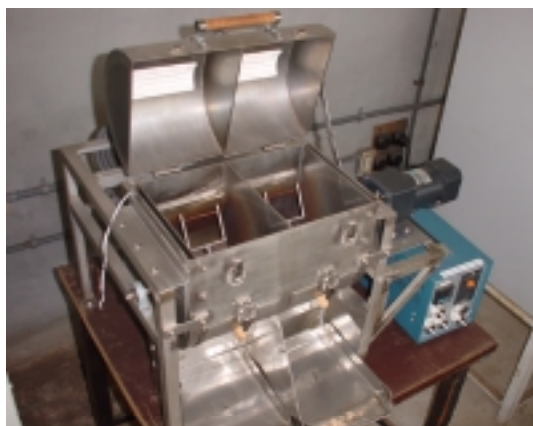
図7 開発した微量炒り葉機
