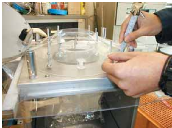
図4 透明ルーバを使った室内試験
