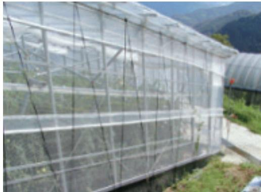
図3 防虫ネット組込平張型傾斜ハウス
