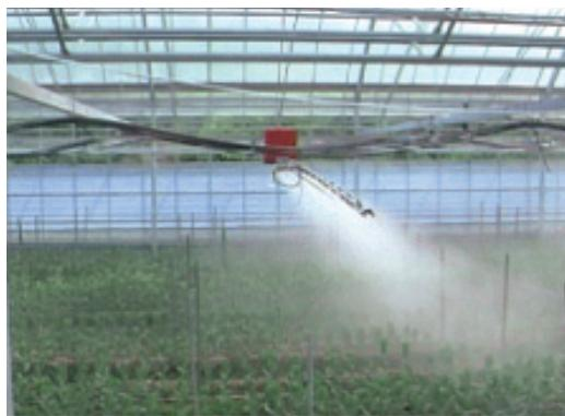
図9 レール式自動薬剤散布機によるトルコギキョウ栽培での散布作業
