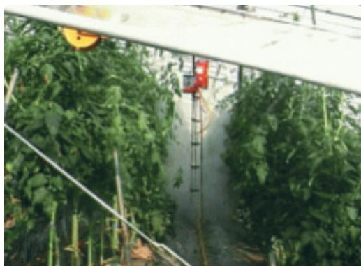
図8 開発したレール式薬剤散布機
