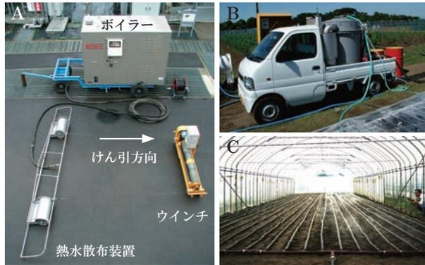
図2 熱水土壌消毒装置のシステム構成
