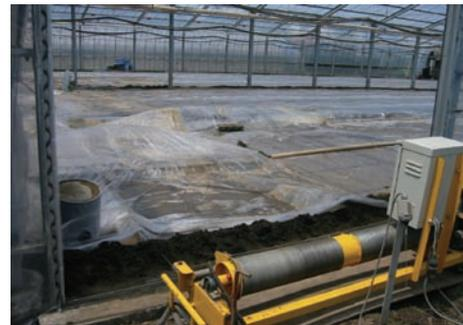
図9 ウィンチ設置部分の横引き牽引
