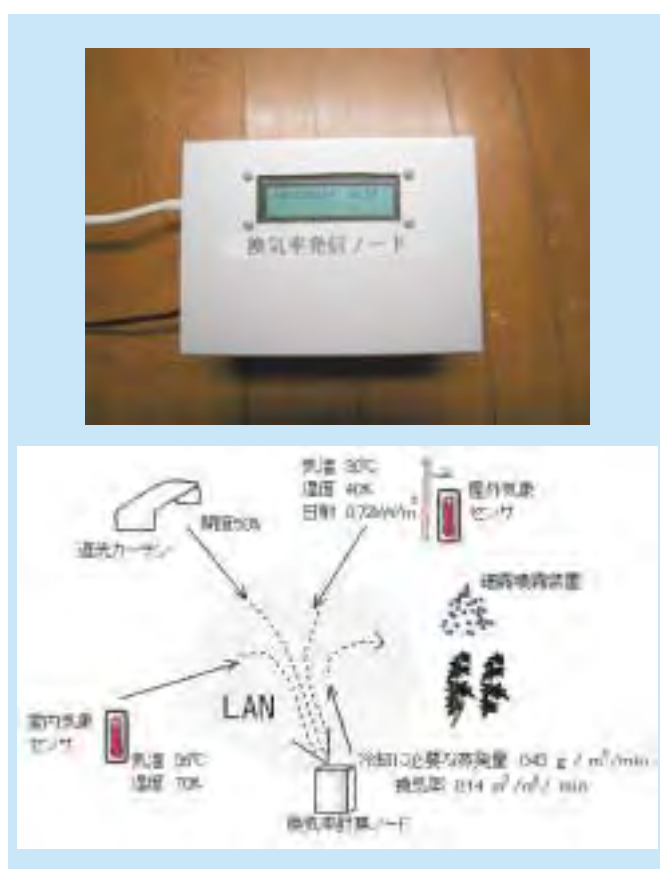
図1 開発した換気率計算ノードとノード動作の概要
