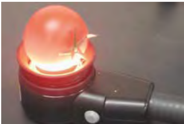
図1 光の拡散反射を利用したトマトリコペンの非破壊計測
