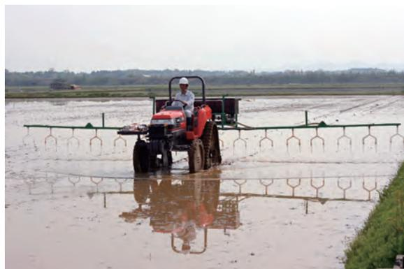
図2.エアアシスト高速条播機の作業の様子
