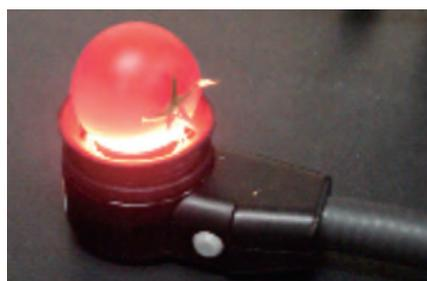
図1.光の拡散反射(インタラクタンスモード)を利用したトマト品質の非破壊計測
