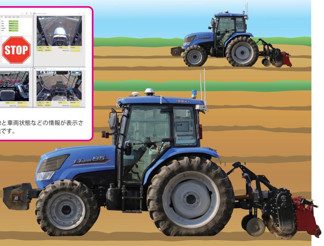
置を手元を持って監視します。ほぼ1日の作業を行った場合で検証した結果、田んぼの耕うん作業、代かき作業とも1台での作業に比べて1.6倍の能率が得られています。
