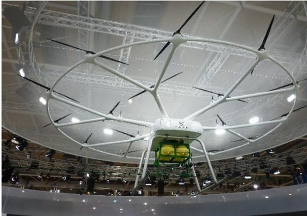
図 3 大型防除作業ドローン
