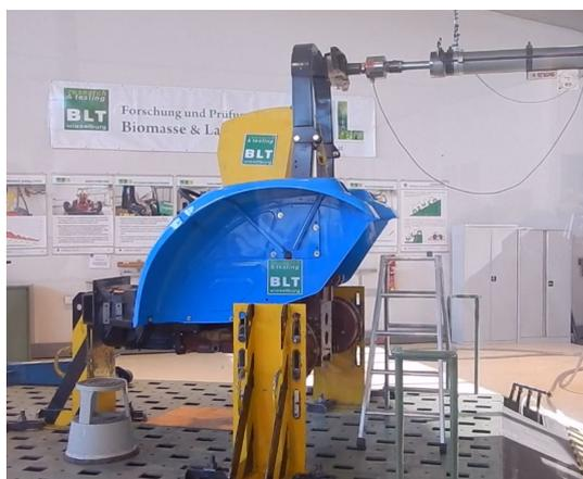
図4 ROPS 強度試験のデモ
