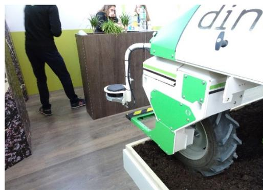
図15 障害物検出のためのLiDAR
