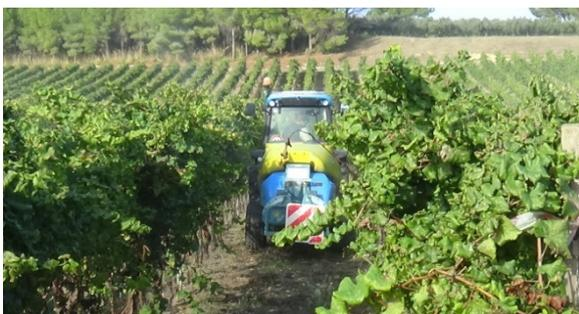
図1 ワイン用ブドウ園トラクタ装着式果樹用防除機(後面より)
