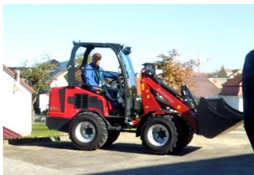
図3 市販電動ローダのデモの様子(Schaffer 23e、走行用モータ21kW、作業用モータ9.7kW)
