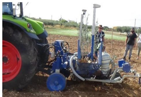
図5 自動走行果樹苗植え機（左：後方、右：側方）
