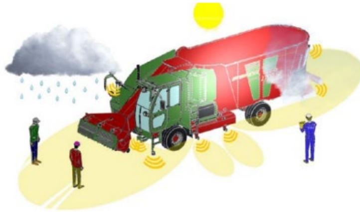
図 21 自動運転のミキサーフィーダーの認知システムの概要 (収集資料 4)
