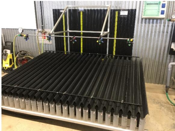
図5 落下量分布測定装置
