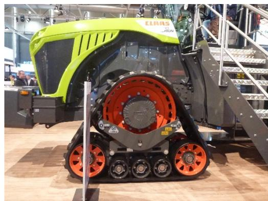
図 24 大型トラクタ用前輪クローラコンセプトモデル
