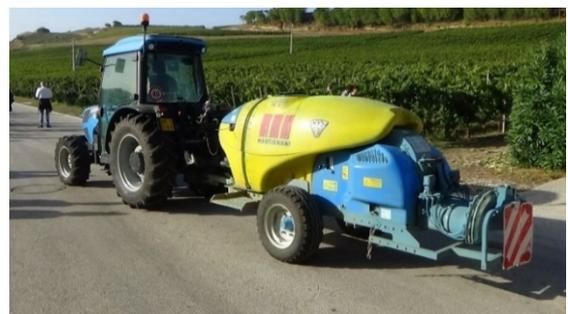
図2 ワイン用ブドウ園トラクタ装着式果樹用防除機(斜め後ろより)
