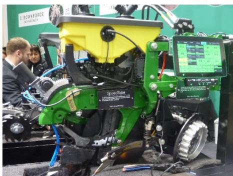
図 23 土壌センサーが組み込まれた真空播種機ユニット
