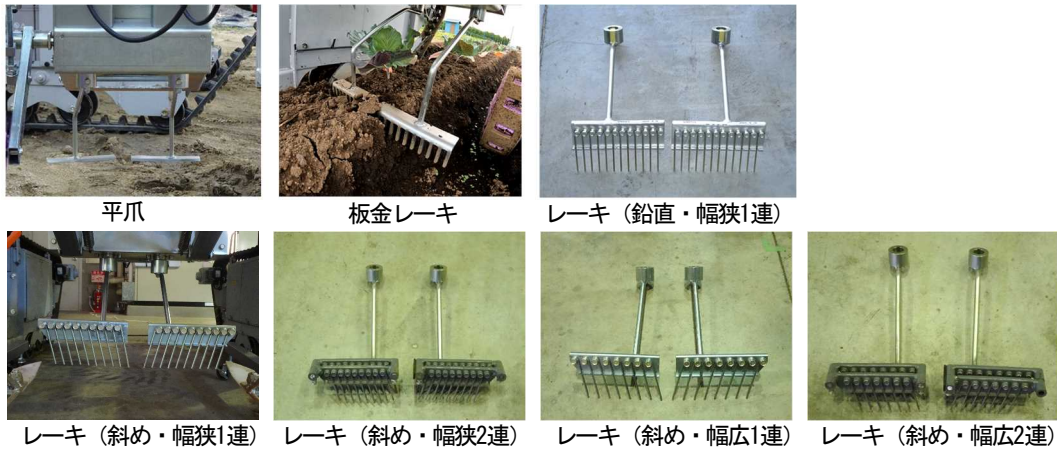
図2 試作した株間除草作用部 (上段: 2022年度供試、下段: 2023年度供試)
