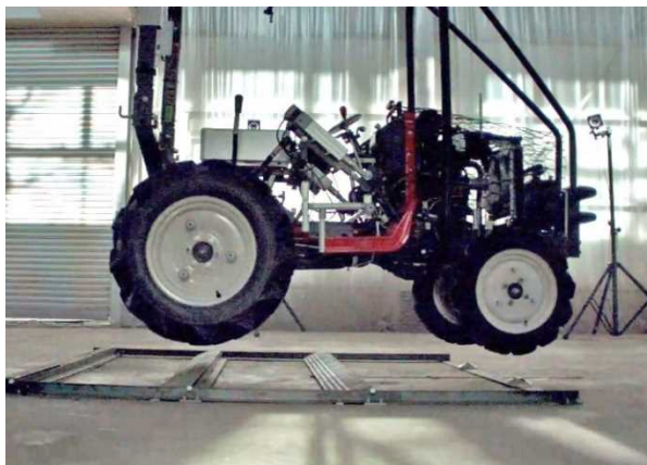
図5 3.7 m/sで段差50 mmに乗り上げてジャンプするトラクタ
