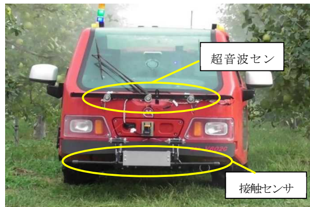
図2 超音波センサ及び接触センサ
