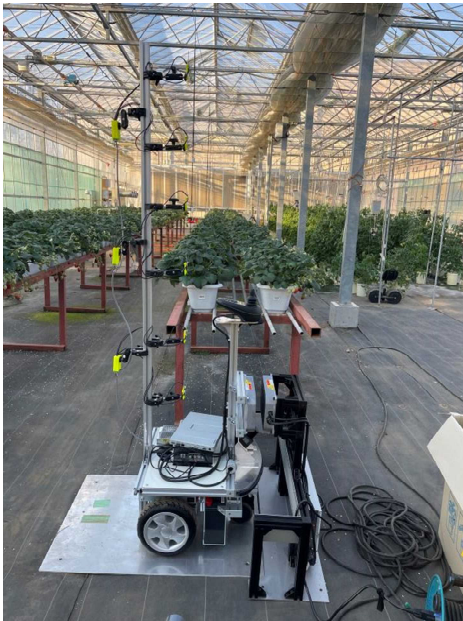
図1 試作した自律走行ロボット および充電ステーション
