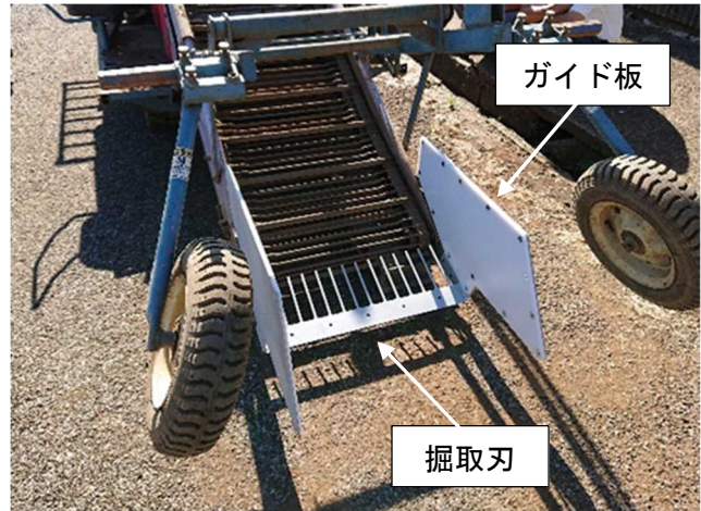
図２ イモ類収穫機に装着したヤマトイモ用の掘取刃・ガイド板
