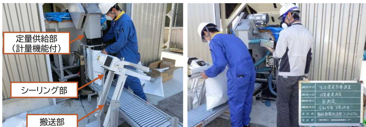
図1 試作した袋詰め装置と粉じんばく露測定の様子
