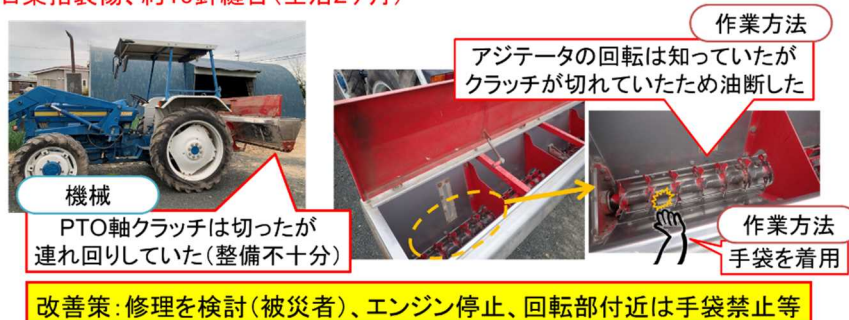
図1 農作業事故現地調査事例（トラクタ作業機に指が巻き込まれた）
