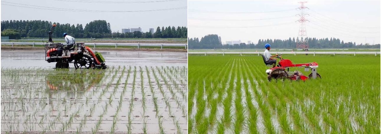
図 両正条田植機試作機による両正条植えと高能率水田除草機による除草作業
