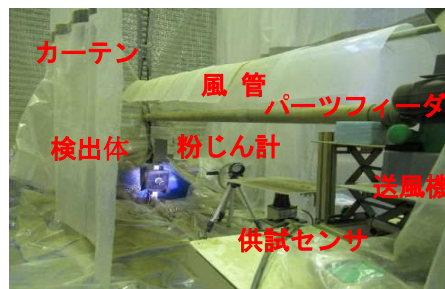
図2 土埃試験装置と検出精度基礎試験(距離1m時)の結果
