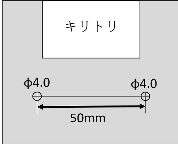
必ず使用前に長さが正しく出力されているか、定規で計測して確認してください
