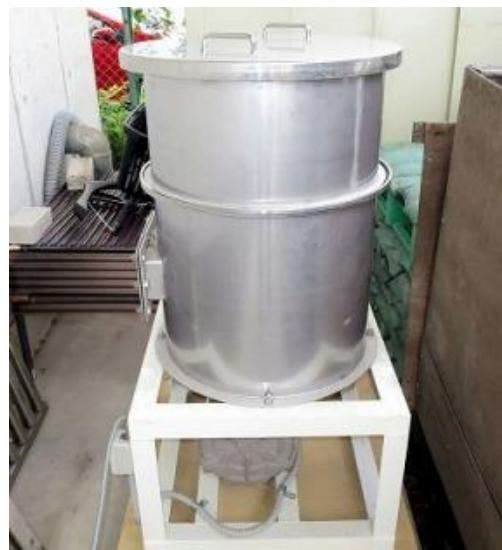
図22 リン化アルミニウム残査取処理機
