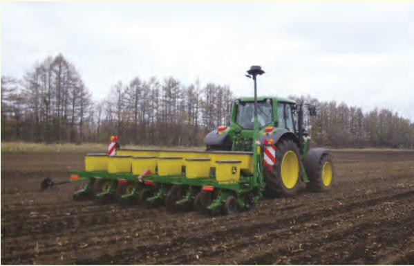
写真2-1. 不耕起播種機による播種風景。
