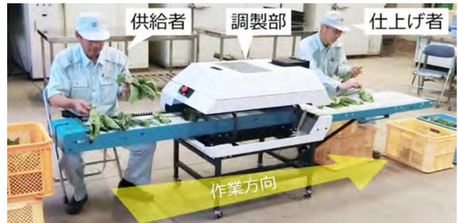
図 高能率軟弱野菜調製機を用いたハウレンソウ調製作業の様子
