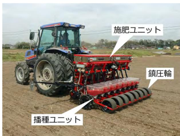
図 高速高精度汎用播種機の外觀
