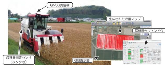
図 開発した収量コンバインおよび出力した収量マップ
