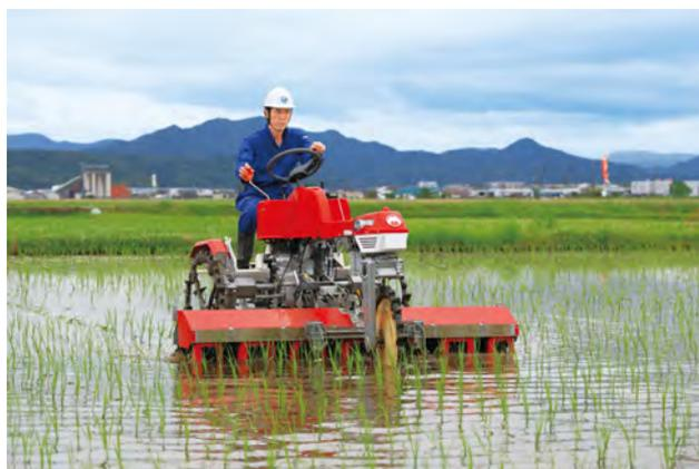
図 高能率水田用除草装置（6条用）による除草作業
