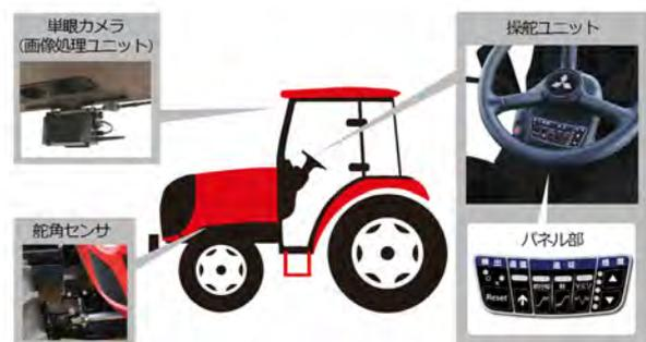
図 直線作業アシスト装置の構成概要
