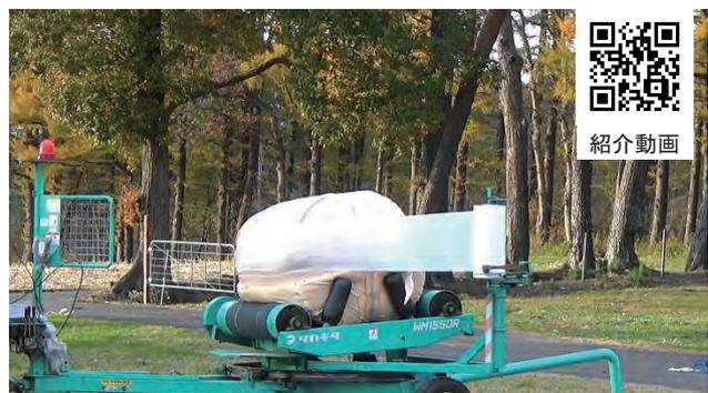
図 フレコンバッグのラッピング作業
