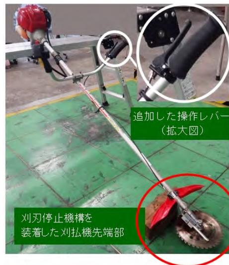
図 刈刃停止機構を装着した刈払機の外観
