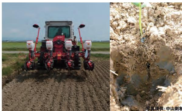
図 スリット成形播種機の概要(左)とスリットによる根の誘導(右)
