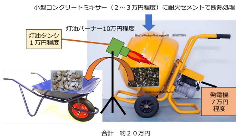
**図IV-5 簡易燃焼装置の概要**
