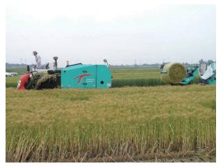
写真2 汎用型機及び飼料イネ専用機によるトウモロコシ・WCS用稲の刈取り同時梱包・ベール調製
