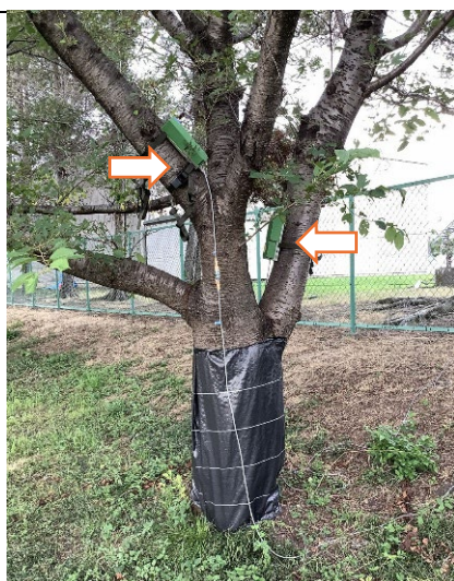
振動発生装置 2 台(矢印)を取り付けたサクラ（足利市内における野外試験）
