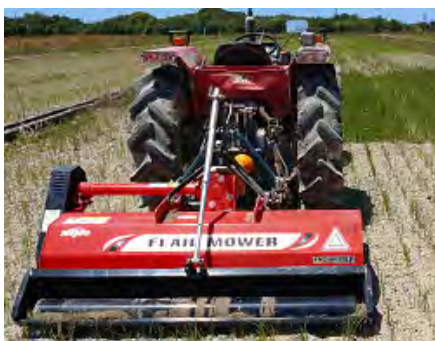
フレールモアによる処理
