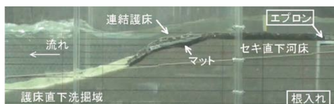
図2 マット工法による堰直下河床の維持状況（模型実験）
