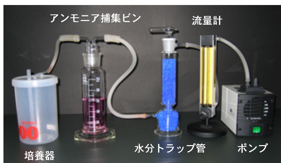
図1 臭気発生装置の概要
