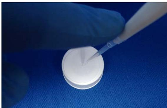
図 10. 円形ろ紙への硝酸銀溶液の塗布
