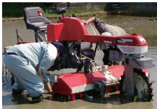
除草機は最速1.2m/sで作業を行うことが可能ですが、欠株や苗の損傷を起こさないために、特に1回目の除草では0.3～0.5m/s（歩くくらいの速度）で作業してください。一筆の中でも田面の高低や耕盤の起伏があるので、作業中も苗の状況などを確認しながら、こまめな調整を行ってください。前記の速度でも、10アール当たり約30分（6条タイプの場合）で作業することができます。
