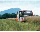
写真/ナタネ油(左)と、ナタネ油100%の燃料で動くコンバインで ナタネを収穫している様子(右)
