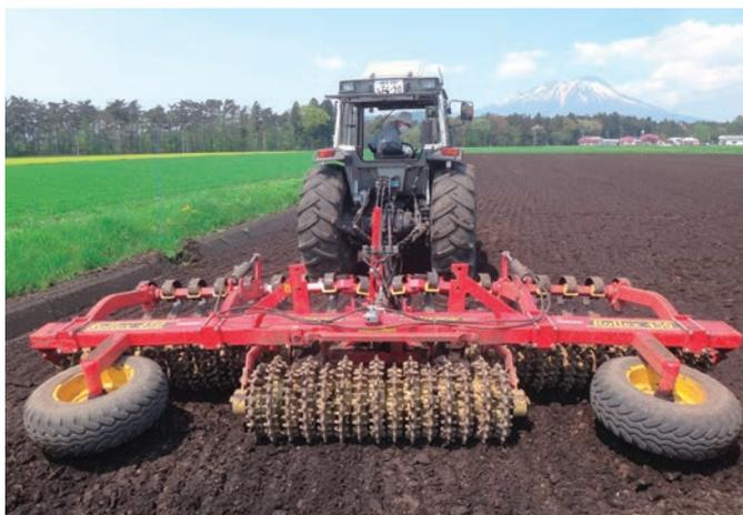
図1 / ハローパッカによる鎮圧作業
