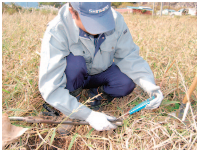
図3／採土器を用いた下層土の土壌ECの測定
