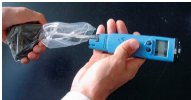
図1／土壌ECセンサの「HANNA社 HI98331 Soil test」
