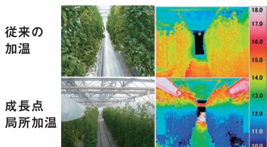
▲ 図1 温風ダクトの配置と温度分布
