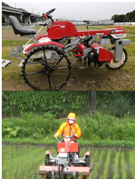
▲写真1 上：高能率水田用除草機 下：現地圃場での実証試験
