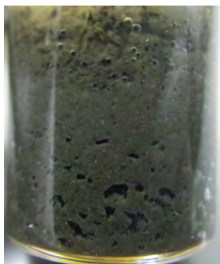
▲写真1 土壌中に発生したガス
