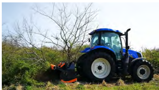
▲写真1 トラクタ搭載型フレールモアによる木本除去作業
