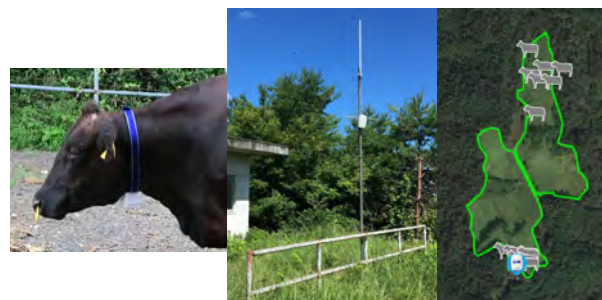
▲写真2 放牧牛管理システム（左）GPS首輪、（中）中継器（ゲートウェイ）、（右）アプリ画面
