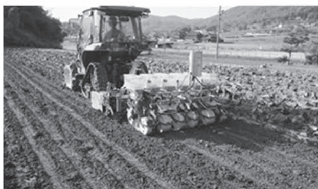
写真3 水稻跡水田のパワーハローシーダーによる麦播種
