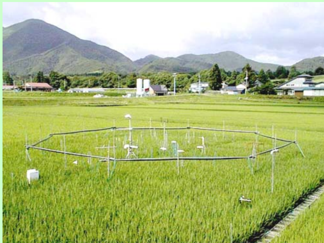
図1 開放系大気 CO 2 増加 (FACE) 実験による水田微気象の変化の測定 (岩手県栗石町)
