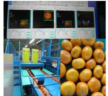
④プレ選果機の選果精度向上するAIによる選別機能を搭載
