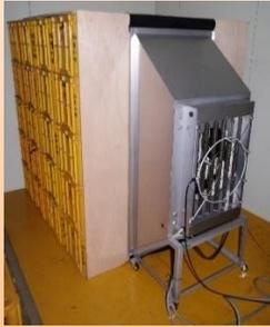
約1000株の苗を処理中の小型ポータブル式蒸熱処理防除装置
