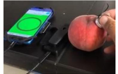
モバイル型音響振動装置(ゆびけん) 一点式センサーが搭載され生産現場での収穫熟度判別などの実用性が向上
